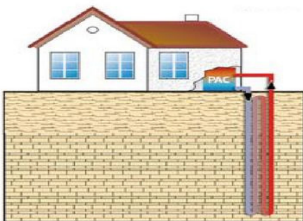
Sonde géothermique verticale
